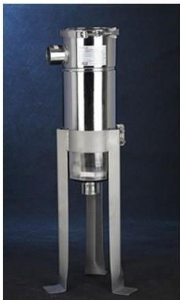
Les corps de filtre Inox à poche de 7'' sont utilisés dans de nombreux process modernes. Le couvercle est équipé du système de fermeture V-Clamp ce qui permet de travailler à des pressions pouvant aller jusqu'à 10 bar. Deux diamètres et quatre longueurs de corps de filtres sont disponibles. L'entrée se situe sur le côté et la sortie sur le bas. Il est idéal pour les process en continu.
