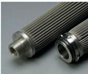
Il existe des cartouches avec membrane PTFE, PBT Meltblown, polyefin (spécialement conçu pour les encres, peintures, résines...) ou encore des cartouches en acier 316L (température d'utilisation jusqu'à 800°C) par exemple, possédant
